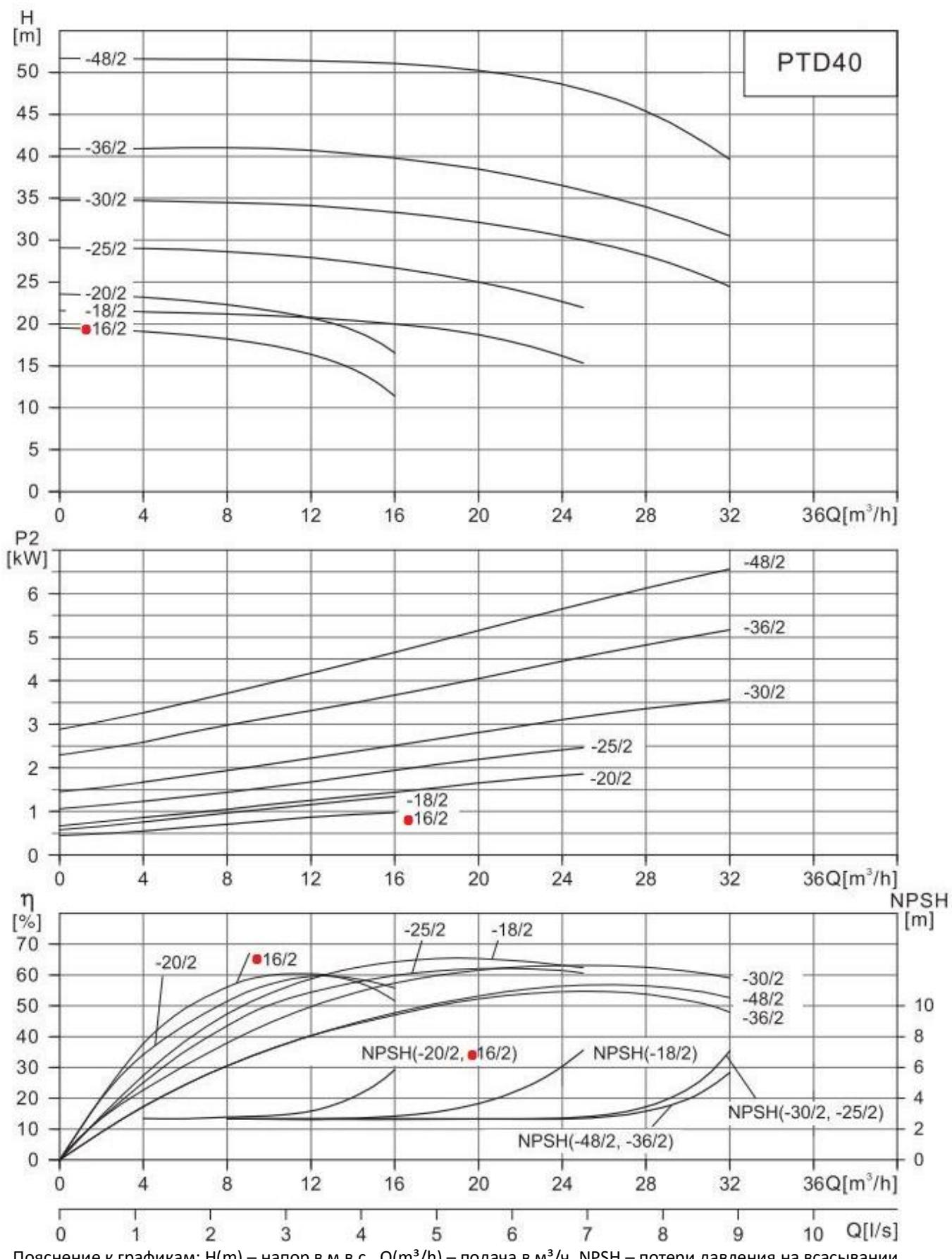
Пояснение к графикам:  $H$ (м) – напор в м.в.с.,  $Q$ (м³/ч) – подача в м³/ч, NPSH – потери давления на всасывании,  $P2$ (кВт) – потребляемая мощность в кВт,  $\eta$  (%) – КПД в %. Измерения проводились для чистой воды, температурой 20°C и вязкостью 1 мм²/с
