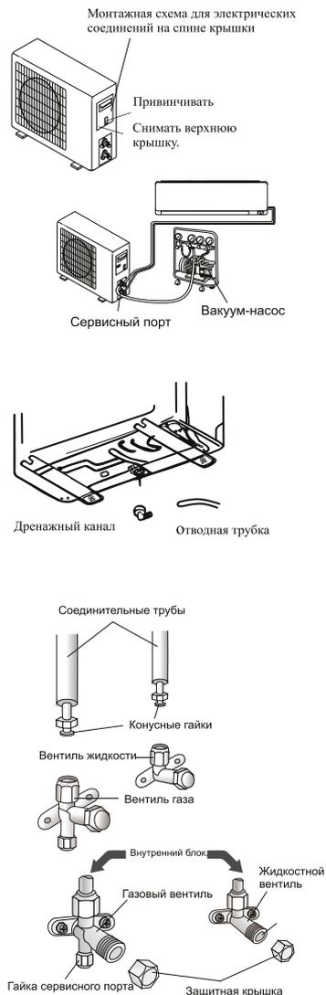
1. Отвинтите и снимите крышку из трехходового или четырехходового клапана.
