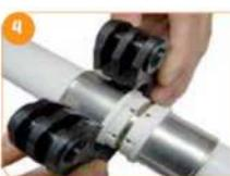
Чтобы снять пресс-хомут с пресс-соединения, необходимо ослабить два подвижных сегмента хомута.
