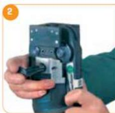
Подобрать необходимого типа промежуточную насадку в соответствии с размером. Для пресс- машин с электронным контролем для размеров 40 мм – 63 мм установить промежуточную пресс-насадку ZB 303 (SANHA каталог № 6931.4) или для пресс- машин с безусловным прессованием – пресс-насадку ZB 203 (SANHA каталог № 6930.1) и закрыть упорный болт.
