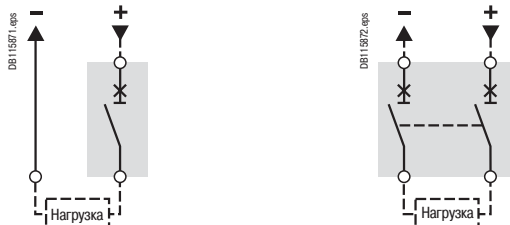
Выбор 1: стационарный 1-полюсный аппарат Compact NSX160N DC
