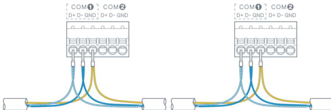
Рис. 28 - Организация подключения проводников RS-485
