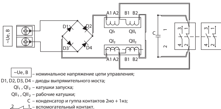
Рисунок 11. Схема электрическая принципиальная вакуумного контактора КВТ-1,14-2,5/63, 2но+1нз
