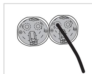
6. Установить в отверстия монтажные коробки.
