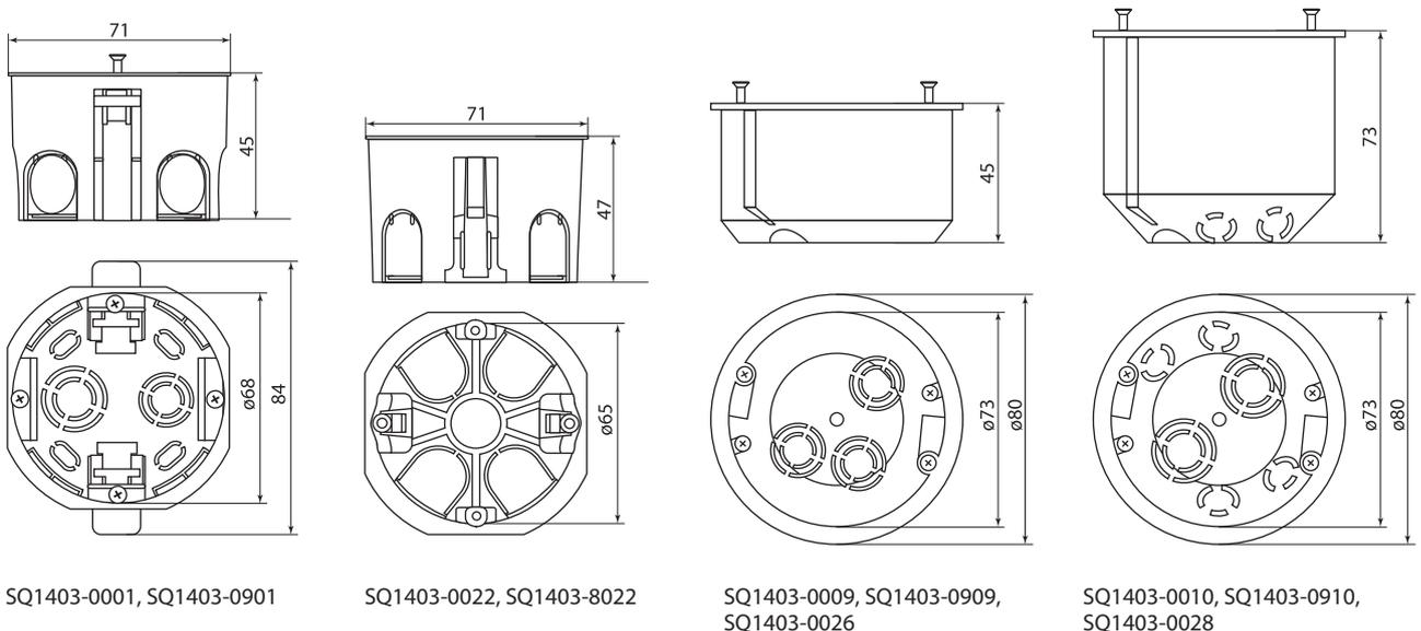
КОРОБКИ МОНТАЖНЫЕ ДЛЯ МОНОЛИТНОГО СТРОИТЕЛЬСТВА
