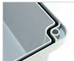
Уплотнитель по периметру крышки обеспечивает степень защиты от проникновения пыли и влаги IP55. Без уплотнителя коробки имеют степень защиты IP44.
