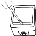
3.1. Снять клавишу путем отжатия лезвием плоской отвертки боковой стенки клавиши.
