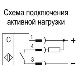
Схема подключения активной нагрузки
