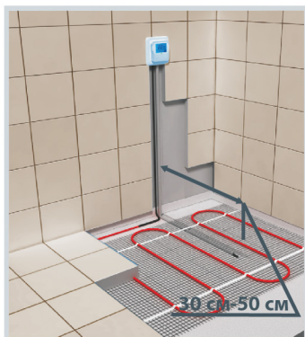
Схема укладки датчика температуры в гофрированной трубке
