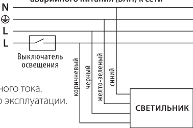
Схема подключения светильников с блоком аварийного питания (БАП) к сети
