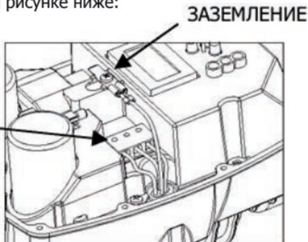
Для выполнения электрического соединения извлеките трехполюсную клемму зеленого цвета с надписью «MOTOR» («ДВИГАТЕЛЬ») и подсоедините три провода питания насосного двигателя; затем установите клемму на свое место и прикрепите заземляющий провод к одному из концов двойного крепления заземления. Обжим клемм крепления должен производиться специально обученным персоналом с помощью соответствующих обжимных щипцов.
