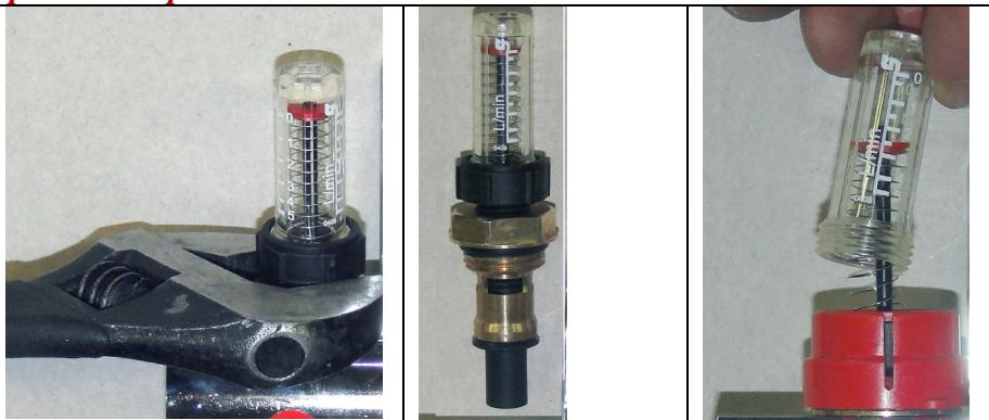
Для замены клапана открутите его от коллектора за латунную гайку
