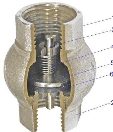
Клапан состоит из составного никелированного корпуса (поз. 1 и 2) из латуни CW 617N, в котором расположен подвижный золотник, состоящий из латунного штока (3), латунных золотниковых тарелок (5), между которыми помещена золотниковая прокладка из EPDM (6). Возврат золотника в седло обеспечивается пружиной (4) из нержавеющей стали AISI
