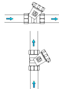
5.2. При направлении потока снизу-вверх, необходимо выполнить горизонтальный участок для правильной установки фильтра, иначе установка фильтра приведет к засорению нижнего отвода (угольника или тройника) трубопровода. Если горизонтальный участок выполнить не представляется возможным, следует использовать фильтр VT.386.
