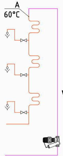
*В контрольной точке A должна поддерживаться температура  $60^{\circ}\text{C}$ . При расчетном циркуляционном расходе остывание воды на участке от точки A до клапана составляет  $5^{\circ}\text{C}$ . Клапан должен быть настроен на температуру:  $60-5=55^{\circ}\text{C}$ .*
