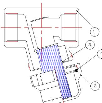
Между пробкой и корпусом располагается прокладка 4 из EPDM. В корпус помещен фильтроэлемент из нержавеющей стали марки AISI 316, стойкой к хлору. Ось колбы фильтра составляет с осью входящего трубопровода угол в 75°. Такая конструкция, при незначительной потере в пропускной способности, позволяет устанавливать фильтр на вертикальных участках трубопроводов при потоке
