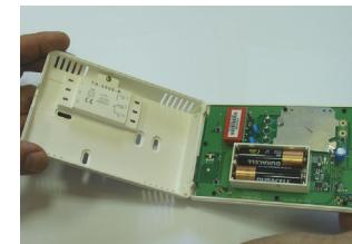
5.4. Отвинтите отверткой винт на нижней половине корпуса и снимите пластмассовую накладку.
