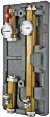
3.1 Модуль предназначен для присоединения высокотемпературного контура системы водяного отопления к коллекторному модулю VT.VAR30. Таким контуром может быть радиаторный контур с температурой теплоносителя равной температуре на выходе теплогенератора, контур бойлера или вентиляционный контур. Модуль снабжен теплоизоляцией из пенополистирола и средствами крепления. Насос в комплект поставки не входит и заказывается отдельно, в зависимости от гидравлических характеристик присоединяемого контура.
