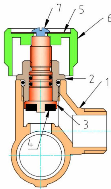
Коллектор состоит из латунного никелированного корпуса 1, имеющего на концах присоединительные резьбы (с одной стороны внутреннюю, с другой наружную) и встроенных в корпус регулировочных вентилей.
