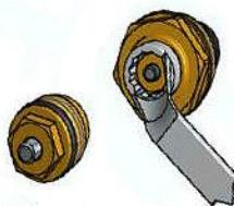
6.5. При течи из-под штока термостатического клапана, головка клапана может быть снята, отремонтирована или заменена. Головка отвинчивается с помощью гаечного ключа. Сливать воду из коллектора при этом не нужно.
