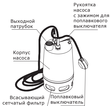
Рис. 1 Конструкция насосов APV.06 / APV.40 V
