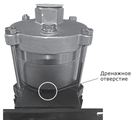
Рис. 11 Дренажное отверстие торцевого уплотнения
