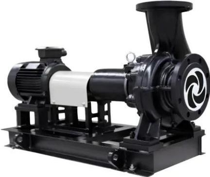
Насосы оснащаются асинхронными электродвигателями с воздушным охлаждением. Подшипниковый узел может быть изготовлен в различных исполнениях в т.ч. для тяжелых условий эксплуатации. Насосы оснащаются механическим торцевым уплотнением вала, а в проточной части монтируются специальные бронзовые щелевые уплотнения, увеличивающие срок службы элементов насоса. Проточные части насоса и рабочее колесо покрыты коррозионностойким ным покрытием.
