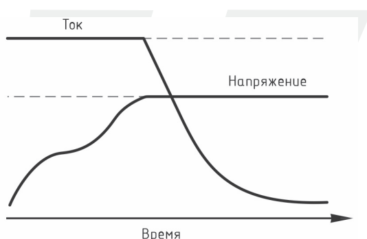
Рис. 5 - Зависимость тока и напряжения от времени при заряде по методу IU
