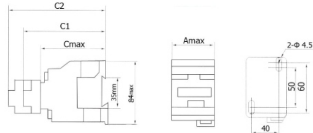
Рисунок 1 – Габаритные и присоединительные размеры пускателей 9 -12А
