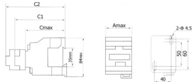
Рисунок 1 – Габаритные и присоединительные размеры пускателей 9 -12А
