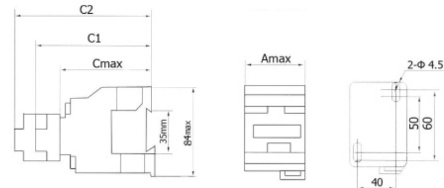
Рисунок 1 – Габаритные и присоединительные размеры пускателей 9 -12А
