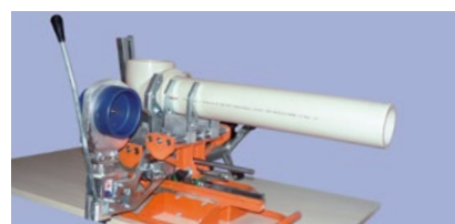
готовое сварное соединение после охлаждения
