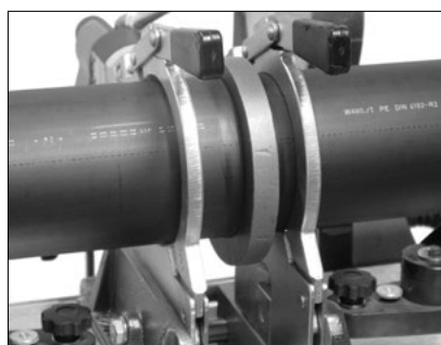
Нагрев нагревательным элементом
