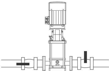
2. Отвернуть резьбовую пробку отверстия для удаления воздуха и медленно залить через заправочную горловину жидкость. Снова вставить пробку для выпуска воздуха и прочно затянуть.
