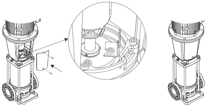
1. Извлеките регулировочную пластину, установите ее в положение, указанное на схеме.
