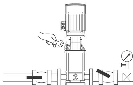
7. Когда жидкость начнет вытекать через клапан для удаления воздуха, закрыть его. Полностью открыть запорный вентиль в напорной магистрали
