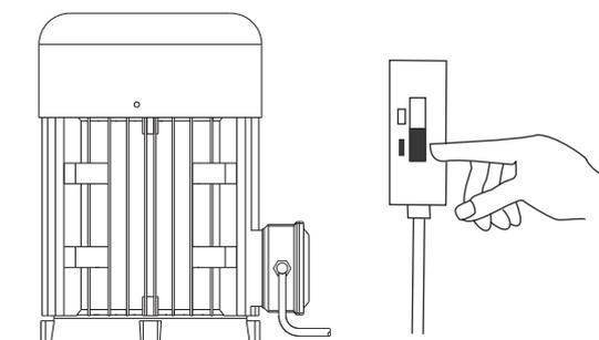
5. Удалить из насоса воздух через клапан для удаления воздуха в головной части насоса. Одновременно немного открыть запорный вентиль в напорной магистрали
