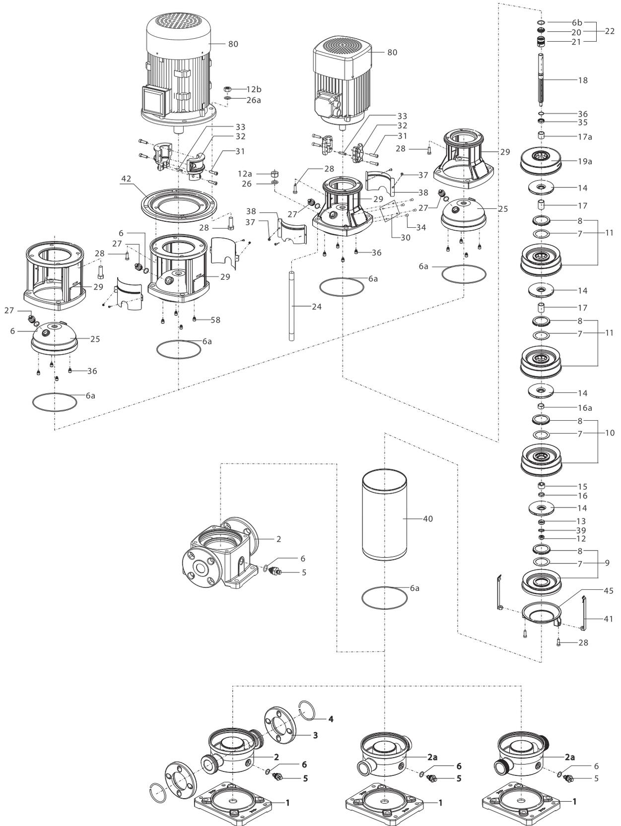
Схема 6. Схема насосов CV и CVF 32, 45 и 64 в разобранном виде
