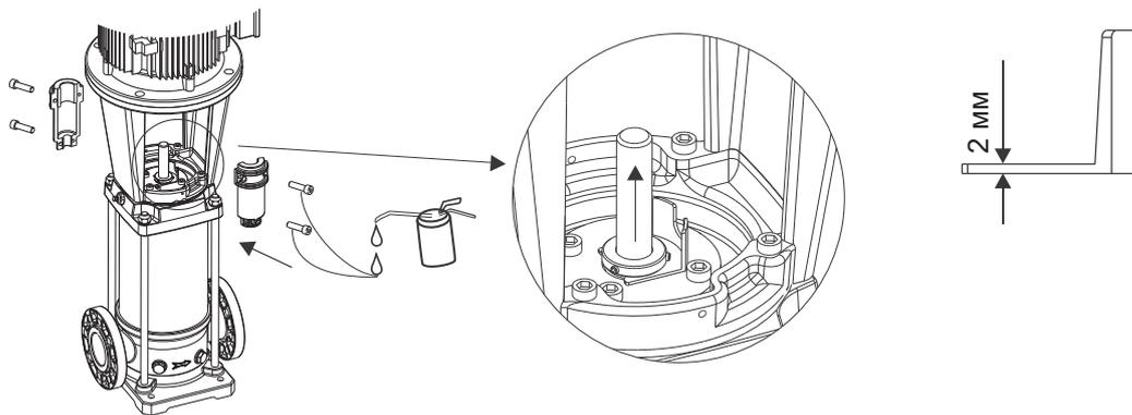
1. Закрутите болт механического уплотнения.
