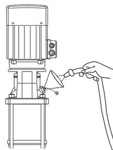
3. Определить правильное направление вращения, указанное стрелкой на головной части насоса и на кожухе вентилятора
