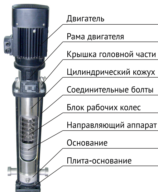
Рис.2. Конструкция насосов
