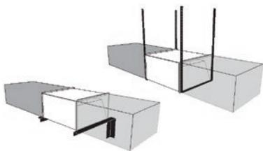
Если вес вентилятора снижает прочность системы воздуховодов, необходимо дополнительно прикрепить вентилятор к полу, стене или потолку.
