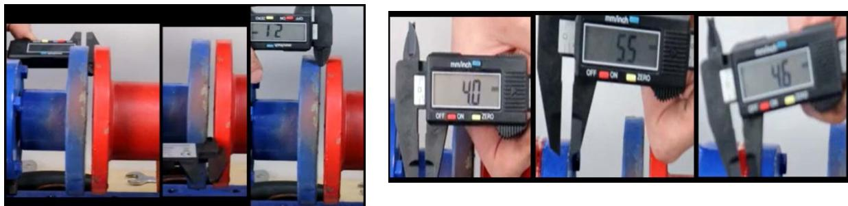
Перед выполнением центровки необходимо определить, какой из агрегатов – насос или двигатель – является стационарным, а какой подвижным. Поэтому за опорную линию с нулевыми координатами принимается ось вращения насоса, по результатам измерений производится центровка двигателя относительно неподвижного агрегата.
