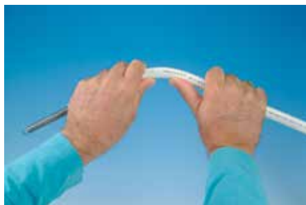
Гибка с помощью внутренней гибочной пружины
