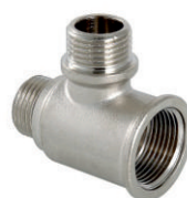
ТРОЙНИК ПЕРЕХОДНОЙ С ДВУМЯ ПЕРЕХОДАМИ НА НАРУЖНУЮ РЕЗЬБУ ВР-НР-НР
