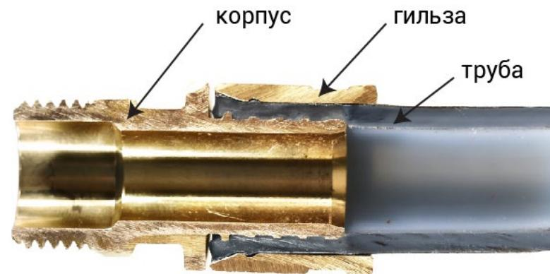
4.1. Корпуса соединителей (кроме *VTm.403* и *VTm.422*) выполнены из горячештампованной (ГОШ) латуни марки CW617N по EN 12165. Гильзы и корпуса фитингов *VTm.403* и *VTm.422* изготовлены токарным способом из прутковой латуни марки CW614N по EN 12165.
